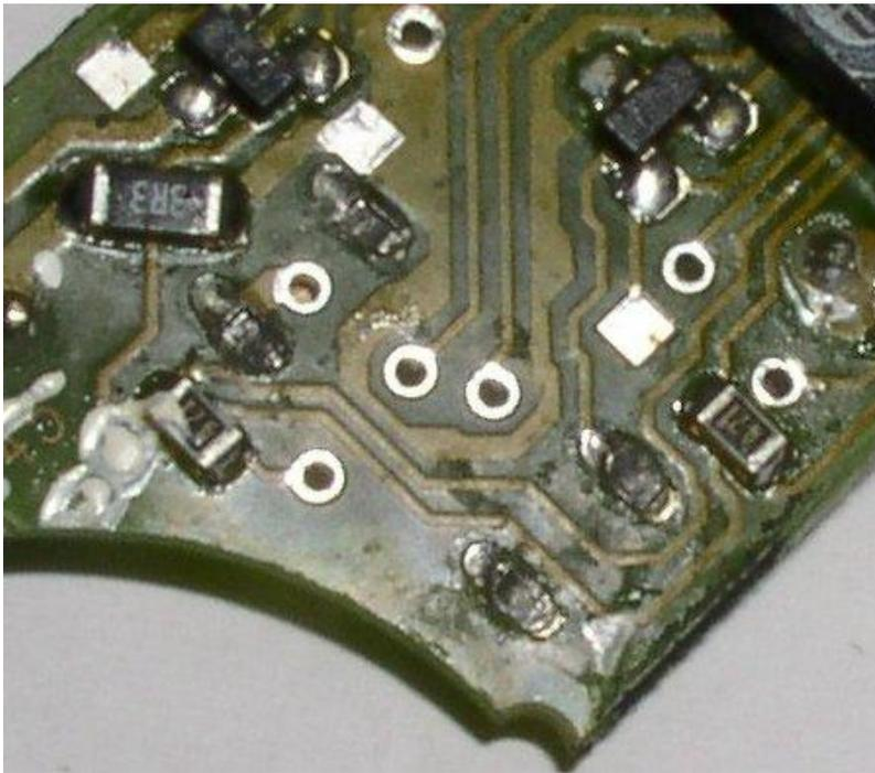
Man nimmt sich also die Platine und entfernt zuerst mal die Reste des alten Lötzinns an den 4 Lötstellen. Das ist zwar nicht unbedingt erforderlich, aber durchaus sinnvoll. Danach kann man den Taster einfach wieder auflöten.
