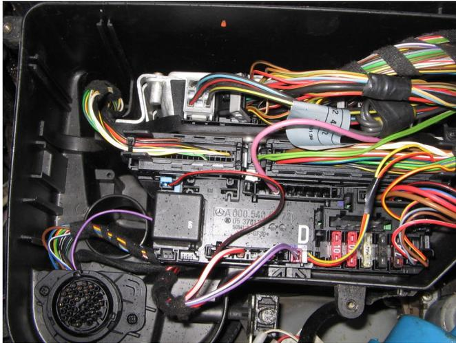
6.2. Den Innenabschnitt des Kabelbaums am Durchbruch zum Innenraum einfädeln und durchziehen. Hier kann ein Drahthaken zum Einfädeln helfen.
