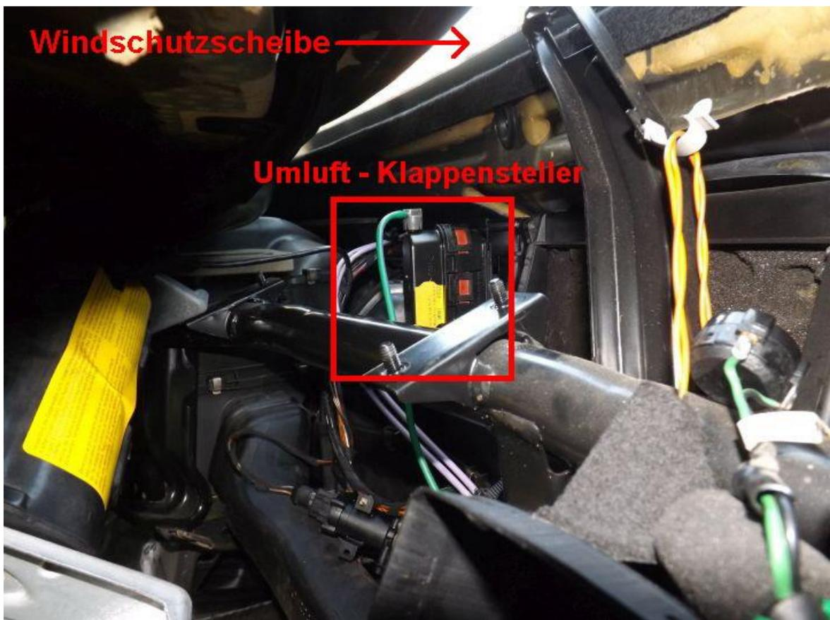
Die meisten helfen sich dann so, das sie die Klappe händisch aufdrücken und mit einem Holz/Styropor verkeilen das sie immer geöffnet bleibt.
