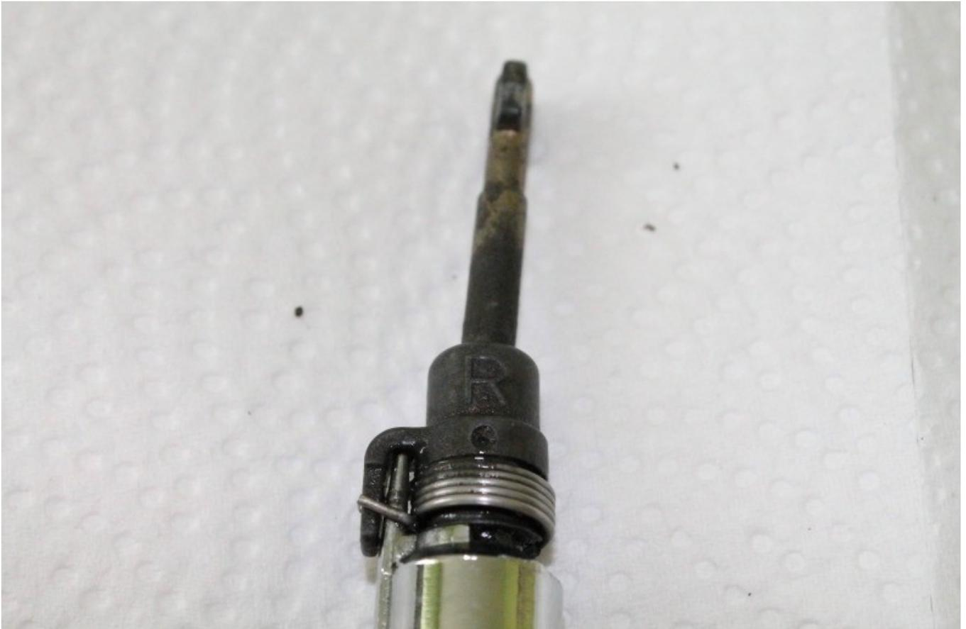
3. Jetzt bekommt man den Schließzylinder raus. Mit dem Schlüssel rein und 45 Grad drehen, dann kann man den Zylinder samt Schlüssel raus ziehen.
