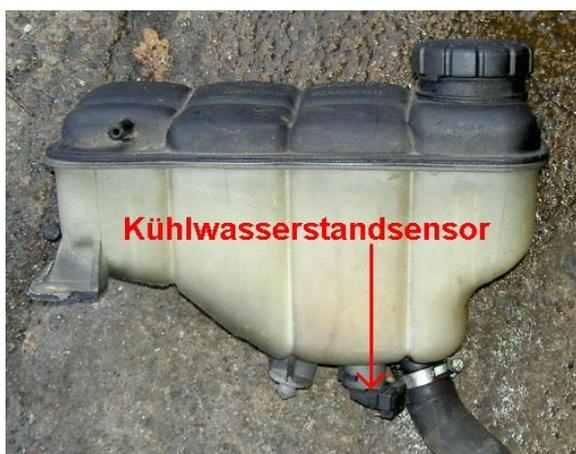
Hier hängen die Sensoren vom Kühlwasser und Scheibenwischwasserbehälter in Serie und es erfolgt eine Widerstandsmessung. Über den Widerstand wird erkannt welcher Wasserstand zu niedrig ist.
