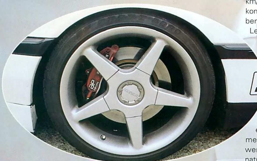
Die 18-Zöller ermöglichen vorne den Einsatz von 320 Millimeter großen Bremsscheiben.
