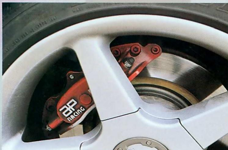
Die AP-Bremsanlage ermöglicht den Stillstand von 100 auf 0 km/h in 38 Metern.
