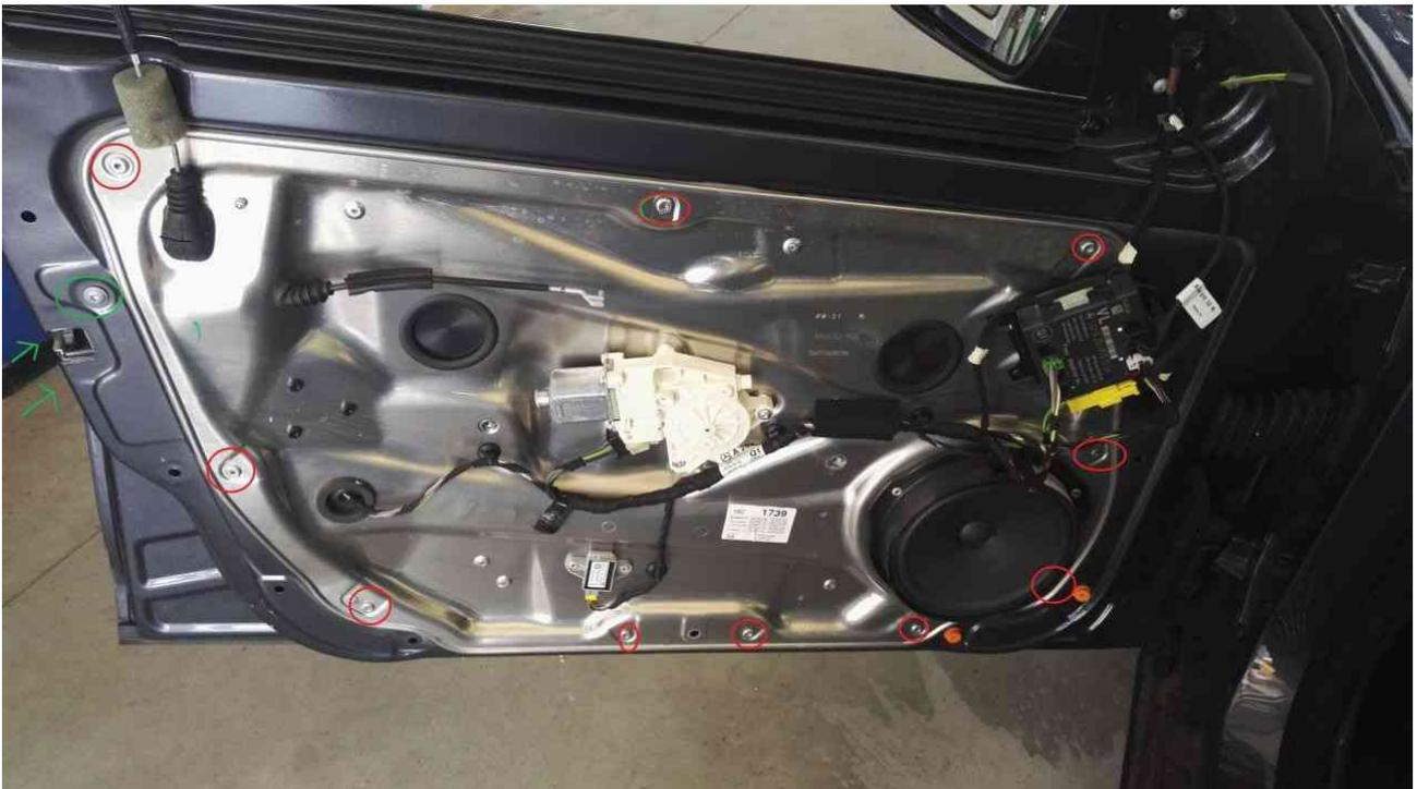
Jetzt blickt man auf den Türträger. Dieser ist mit zehn 6,3mm 6,4mm Niete festgenietet, wie im Bild markiert. Diese müssen ausgebohrt werden, 6,5er Bohrer empfiehlt sich. Hierfür das Fenster noch oben lassen und trotzdem aufpassen nicht immer „durchzuschlagen“ wenn das letzte Bisschen der Niete nachgibt und der Akkuschauber mit dem Futter aufsetzt.
