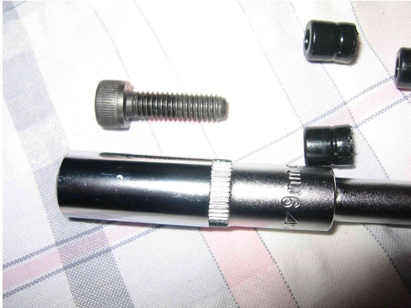
*Auf den Garagenboden eine passende Schraube aufstellen und mit der Hand halten und gegen Umfallen sichern (geht nur mit einem Helfer, der das macht). Das Türmodul so auf der Schraube auflegen, dass genau ein Kunststoffbolzen auf der Schraube zu liegen kommt. Von der anderen Seite mit einer 9mm Stecknuss so dagegen halten und so auf die Nuss schlagen, dass der Kunststoffbolzen in die Nuss getrieben wird. Im nächsten Bild also einfach auf das Holz schlagen.*
