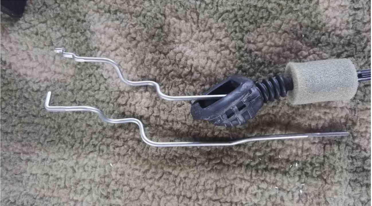
Oben im Bild ist die alte Zange noch mit Gummi und Knöppes, unten die neue. Die alte wird (wie den Modellbauern von Servos bekannt sein dürfte) durch zweimaliges 90-Grad-drehen sicher eingehangen. Das geht nur im soweit zerlegten Zustand wie hier, wenn das Schloss komplett herausgenommen wird. Die neue Stange ist nur einmal abgewinkelt und lässt sich somit auch ohne kompletten Ausbau durch das Loch des Türträgers einhängen. Eigentlich.
