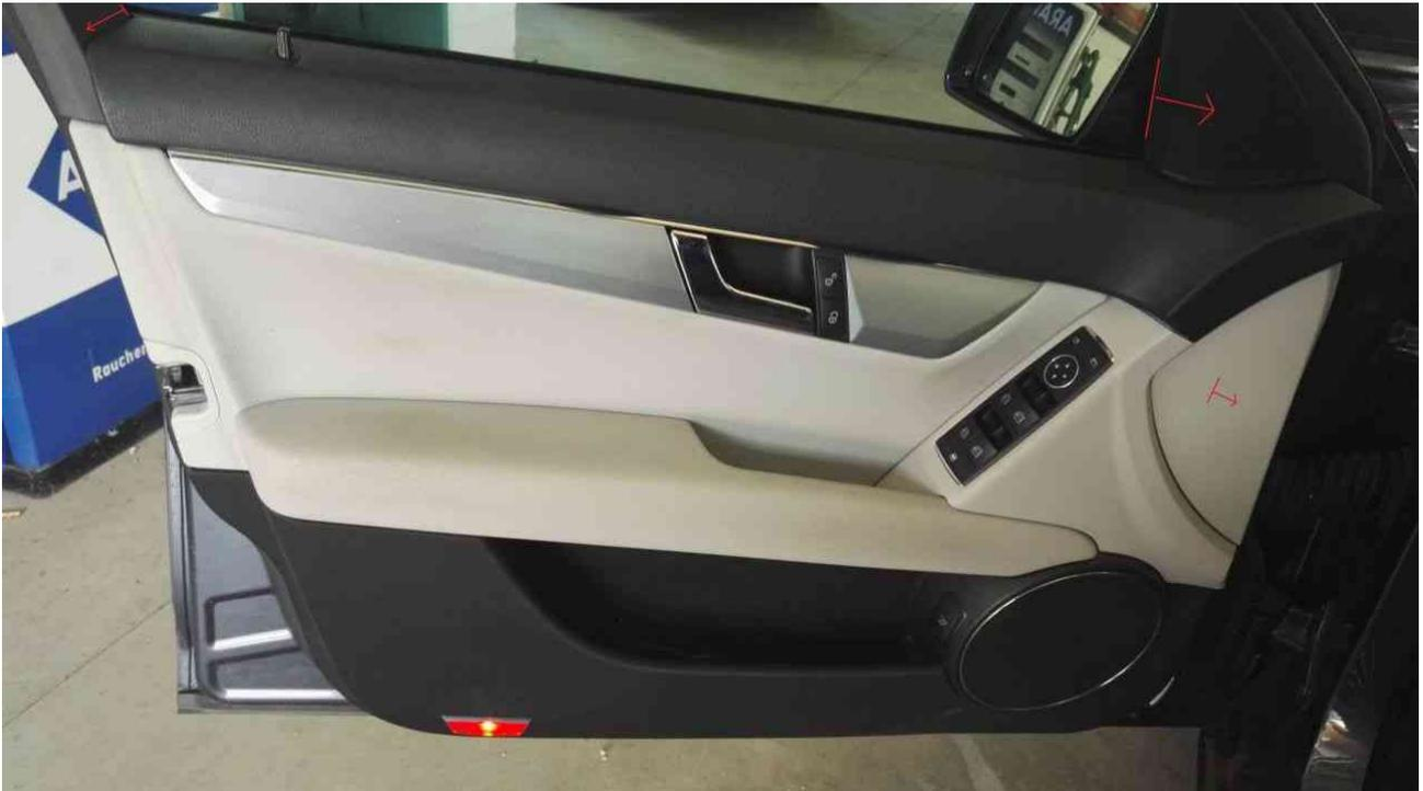
Zunächst mal die Tür aufmachen – logisch. Danach wird der Deckel des Türsteuergeräts weggeclipst, das Fenster runtergefahren und bei offenem Fenster das Lautsprechergitter vom Fenster aus los geclipst, der Schaumstoff entnommen und der LS abgesteckt. Auf der anderen Seite wird die schwarze Verkleidung, die den Fensterrahmen verdeckt, ebenfalls vom Fenster her gelöst und vorsichtig nach Innen gelöst. Jetzt das Fenster wieder hochfahren.
