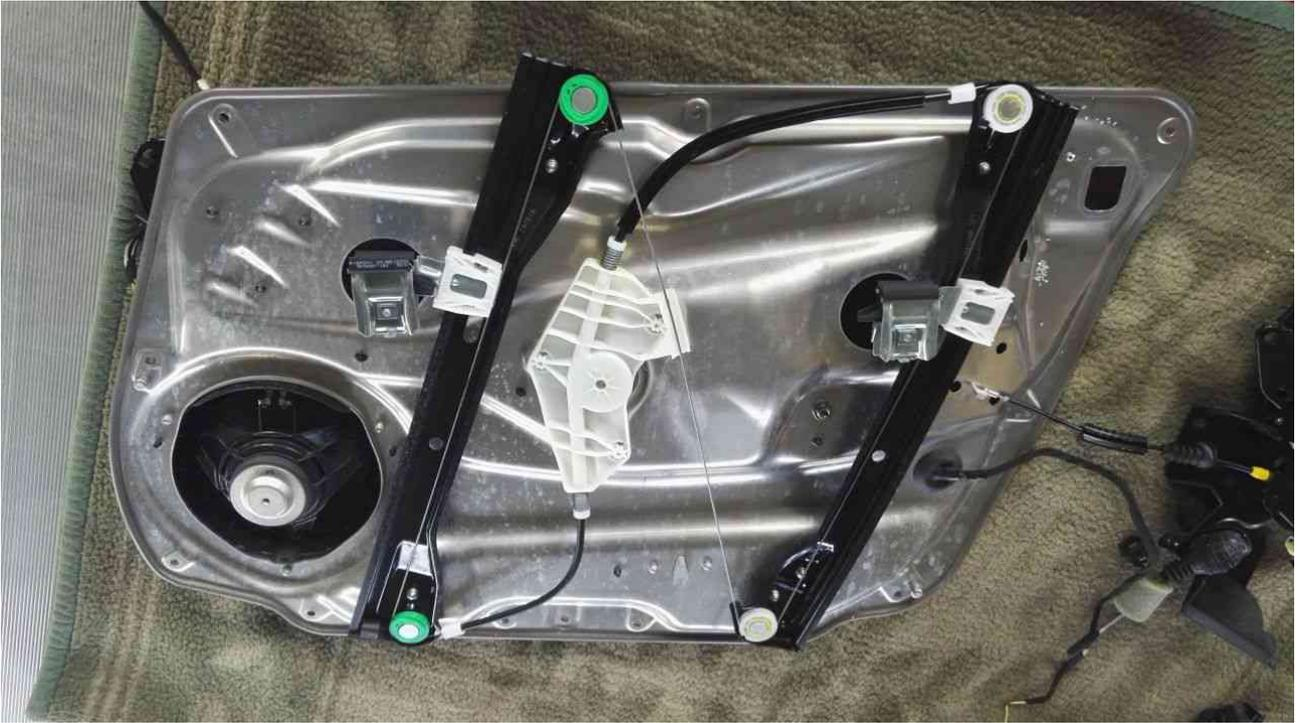
Um nun den Wasserablauf samt Schloss vom dem Türträger zu trennen, müssen von Innen drei Plastikdübel mit einem Durchschlag oder Schraubenzieher gelöst werden (orange markiert), und ein einzelner Niet aufgebohrt (und später ersetzt werden), hier rot markiert.
