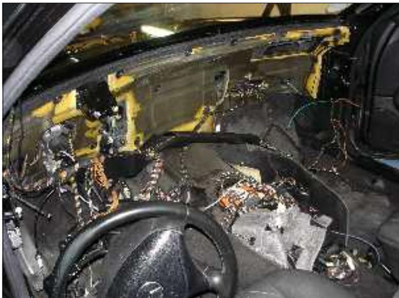
*Abbildung 21: ausgebauter Klimakasten*
