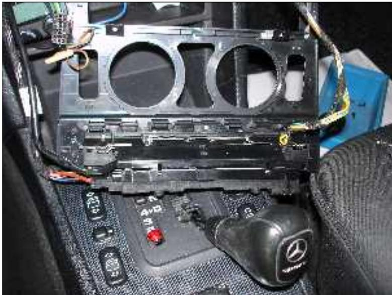
*Abbildung 9: Abdeckung an der Mittelkonsole von hinten*
