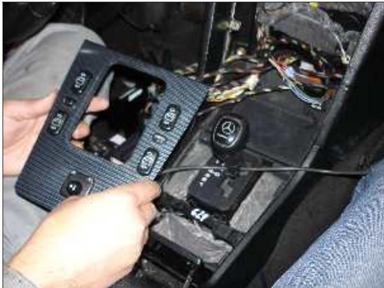
*Abbildung 11: Abdeckung am Schalthebel*
