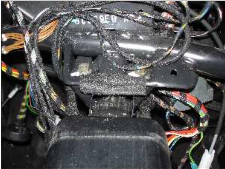
*Abbildung 18: Befestigungsschrauben am Mantelrohr*
