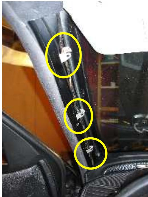
*Abbildung 1: Halteklammern an der A-Säule*
