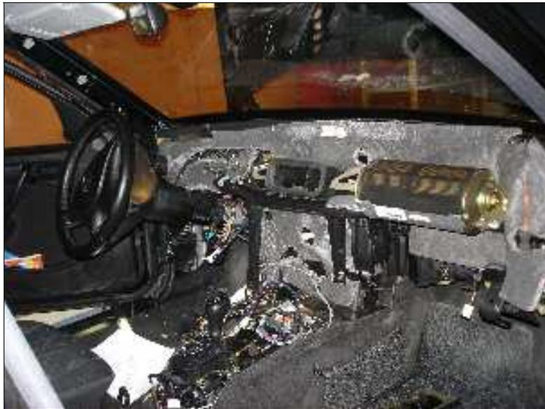
*Abbildung 16: ausgebaute Instrumententafel*
