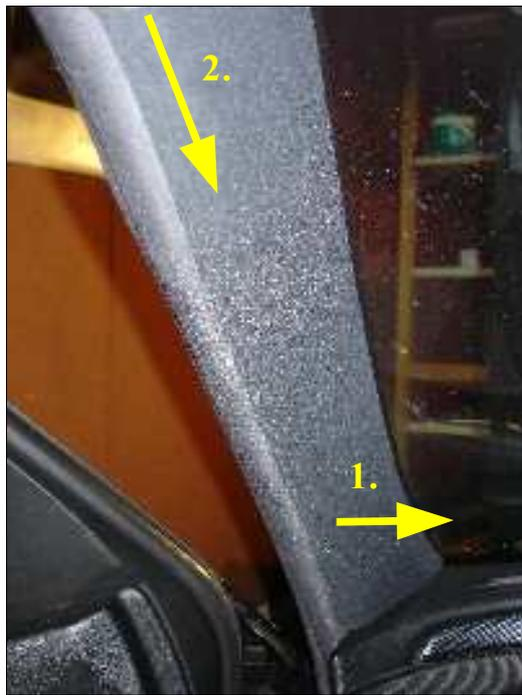
*Abbildung 2: Herausziehen der Verkleidung*
