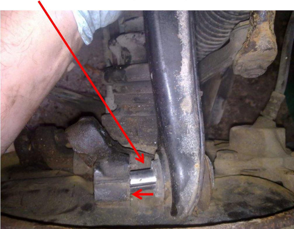
5. Nun die neue Strebe am Radträger fixieren **nicht festschrauben** und die andere Seite der Strebe in die Aufnahme an der Achse. Dabei Vorsicht walten lassen, da das „Loch“ in der Strebe nicht unbedingt mit dem Loch in der Halterung fluchtet, nicht die Schraube mit Gewalt reinklopfen, sondern durch heben und senken, drücken und schieben die „Löcher“ fluchten lassen, und die Schraube sanft hindurchschieben.
