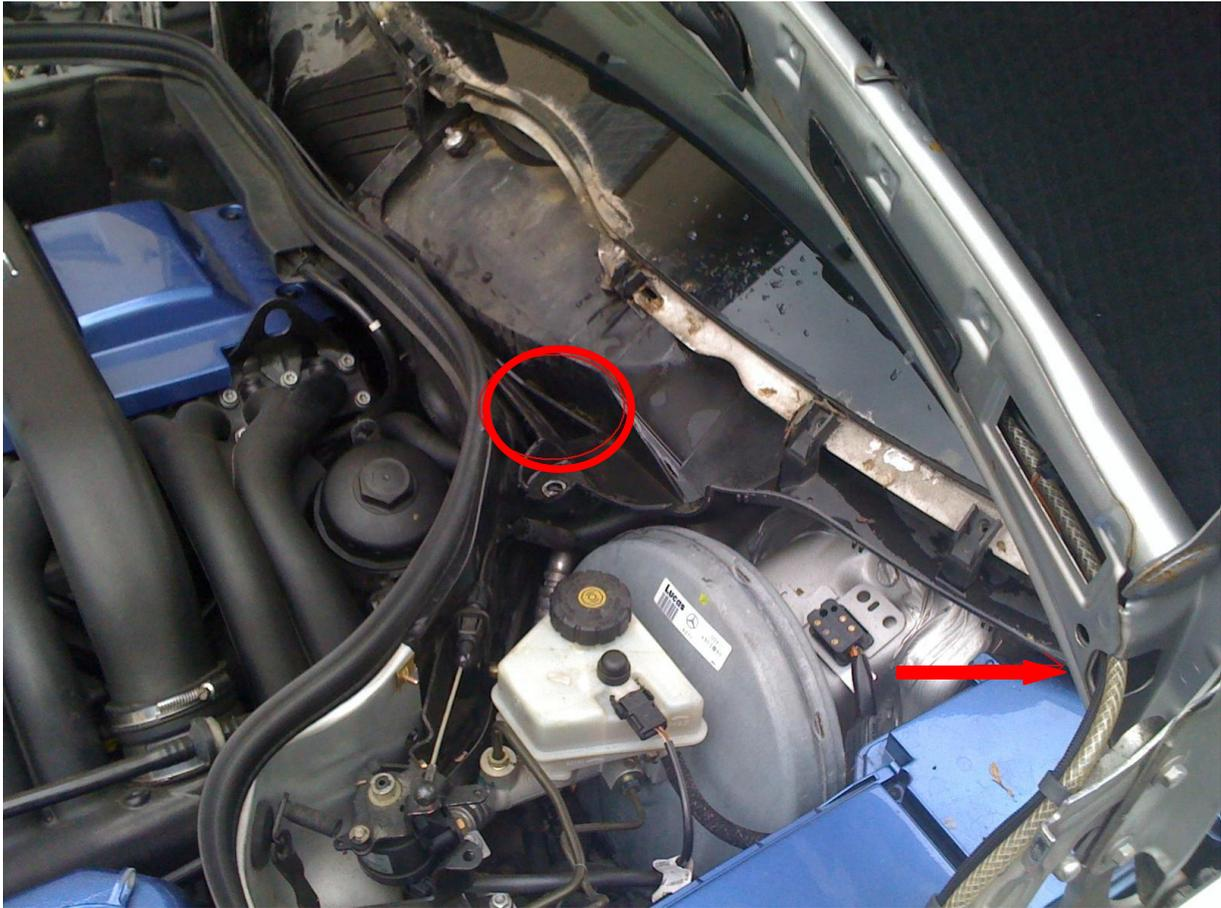
Im Kreis sieht man den mittleren Ablauf unterhalb des Scheibenwischers. Der Pfeil zeigt auf das Ablaufrohr im Eck (siehe Beifahrerseite).
